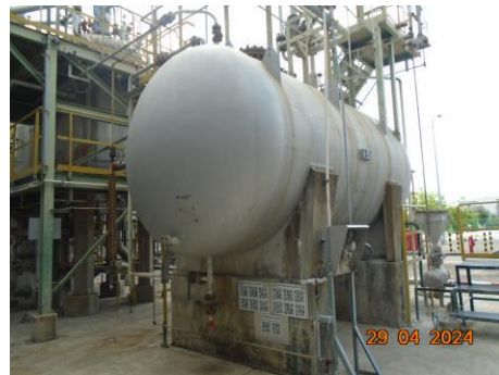
ภาพที่ 2.1-12 ถังรวบรวมของเสียบริเวณ Wastes Hexane Recovery Unit
